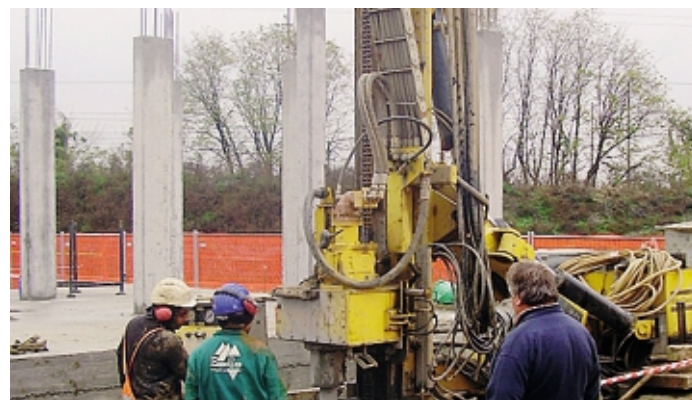
Una trivella per la perforazione di pozzi per l'acqua
